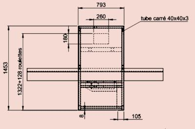
Châssis et carcasse: inox 304L sur roue diamètre 180 mm
